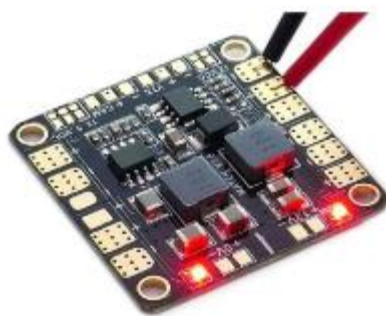
Figura 4. Placa de distribuție a energiei (PDB) a dronei 12
