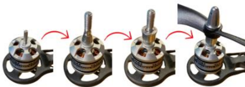
Figura 4. Motorul electric al dronei „7 ” – actuator principal care asigură mișcarea elicei
