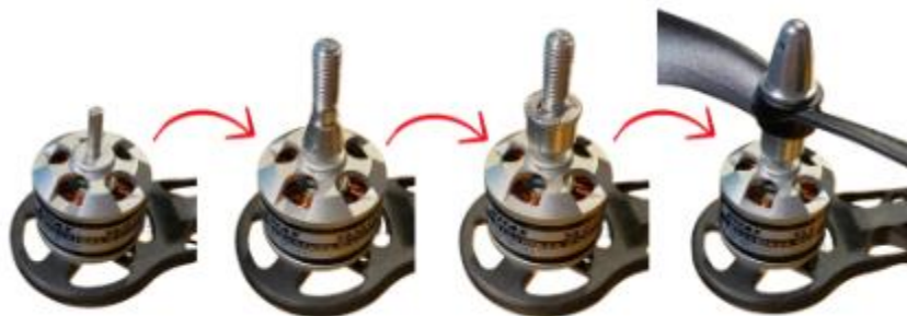
Rysunek 4. Silnik elektryczny drona7 – główny siłownik zapewniający ruch śmigła
