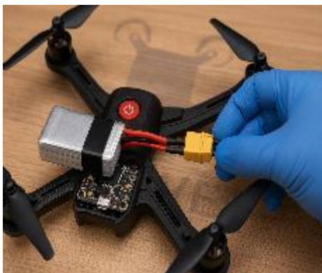
Rysunek 4.5 . Odłączenie zasilania drona w celu bezpiecznej interwencji
