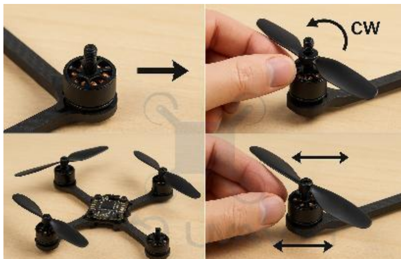
Rysunek 4.9 . Montaż śmigła drona — kontrola kierunku i dokręcenia
