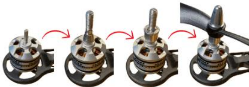
Σχήμα 38: Ηλεκτρικός κινητήρας του ΣΜΗΕΑ - κύριος ενεργοποιητής που παρέχει την κίνηση του έλικα
