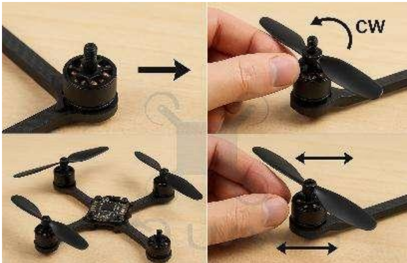
Σχήμα 40: Συναρμολόγηση ελίκων ΣΜΗΕΑ - Έλεγχος κατεύθυνσης και στεγανότητας
